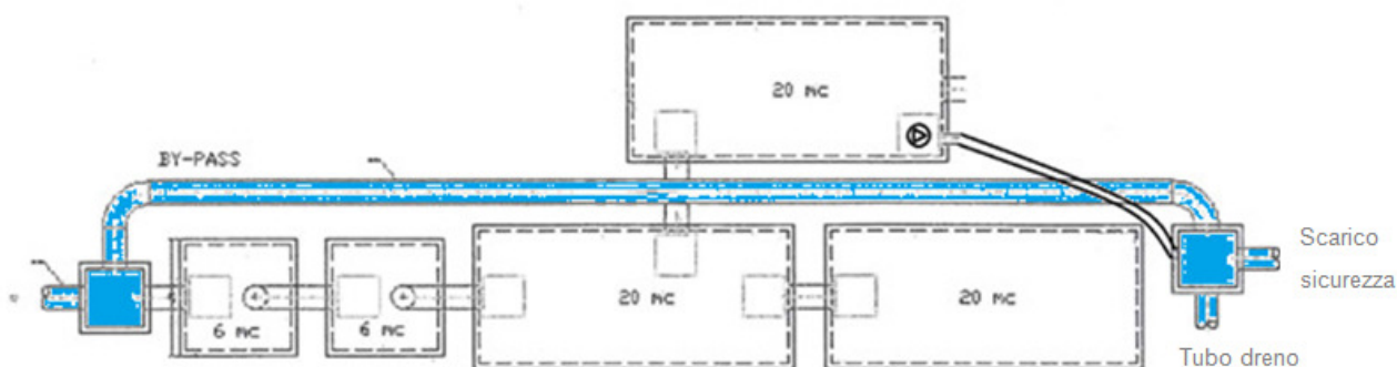
Fig. n. 23 – Schema scarico di sicurezza delle acque di seconda pioggia
